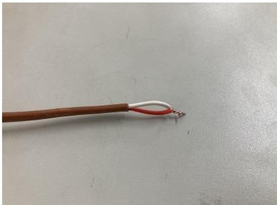
**反対側**(センサ本体側)のケーブル先端も同様にシースと内装被覆を 10mm 程度剥いで電線を出し、ワンタッチコネクタに接続します。
